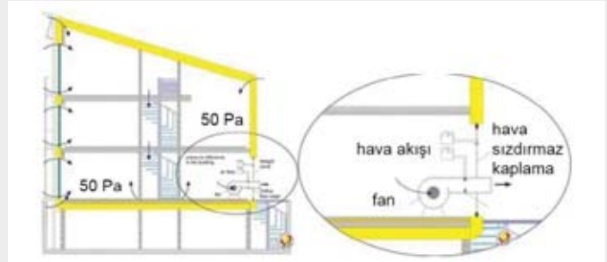
ŞEKİL 1.4 - PASİF EV KESİTİNDE BLOWER DOOR TESTİ PRENSİBİNİN GÖSTERİMİ
