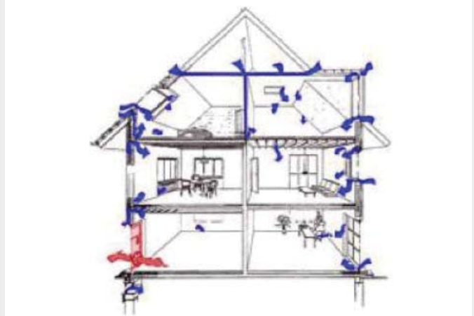
ŞEKİL 1.5 - HAVA BASINCI TESTİNİN ŞEMATİK GÖSTERİMİ
