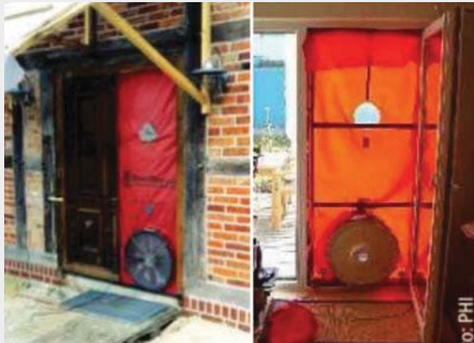
ŞEKİL 1.3 - DIŞ KAPIYA MONTE EDİLEN VANTİLATÖRÜN BİNA İÇİ VE DIŞINDAN GÖRÜNÜMÜ
