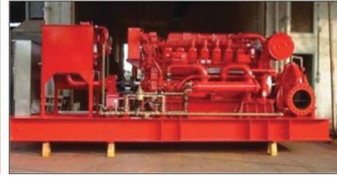
Yangın su pompası
