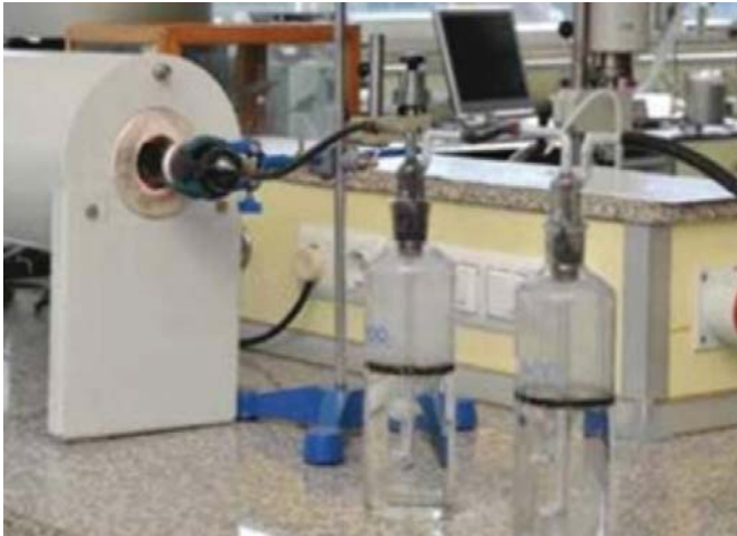
IEC 60754-1 ve IEC 60754-2 yanma sonrası açığa çıkan gazların su içinde biriktirilmesi, pH ve iletkenlik ölçümü
