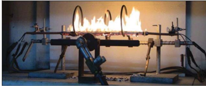
IEC 60331 test düzeneği
