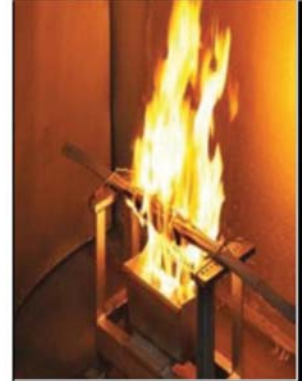
1 metre numune yanma testi
